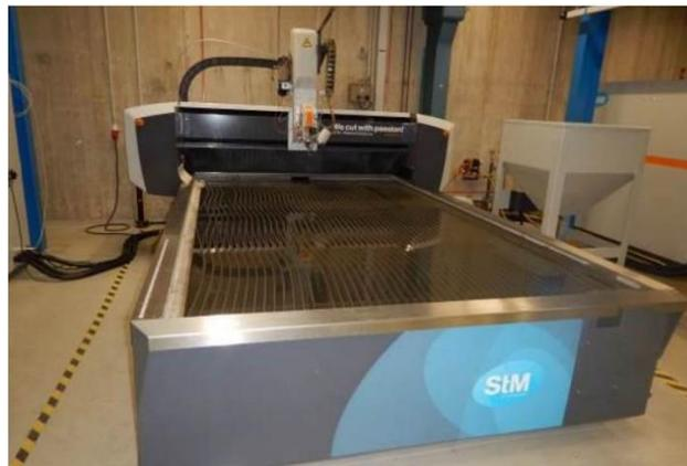
*Bild. 1.* Wasserstrahlschneideanlage.
