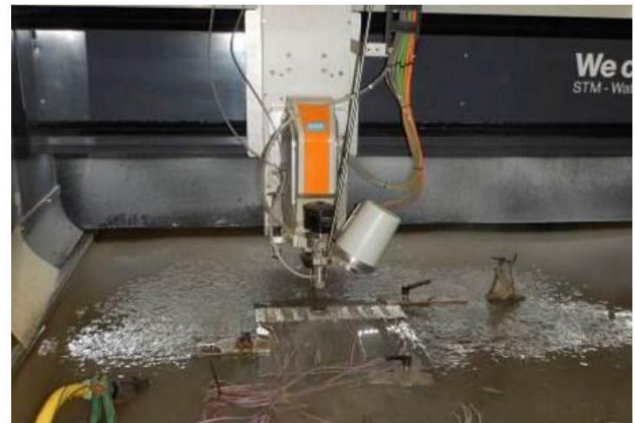
Bild. 1. Wasserstrahlschneideanlage (links) und Wasserstrahlschneiden eines Flanschbleches (rechts).
