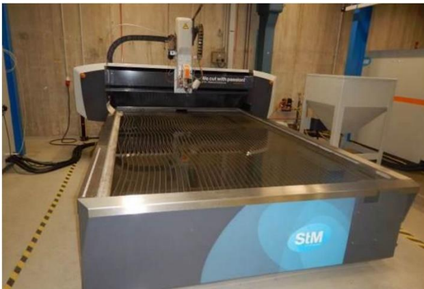
Bild. 1. Wasserstrahlschneideanlage (links) und Wasserstrahlschneiden eines Flanschbleches (rechts).
